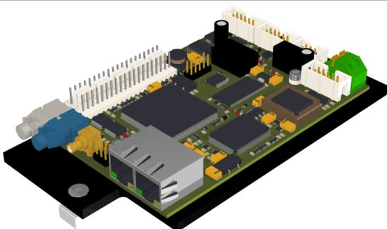
Der **SMM 400 Bus-Master** ist die Schnittstelle zwischen dem Personal Computer (via ETHERNET) und den Systemmessmodulen (über einen RS 485-Ringbus).
